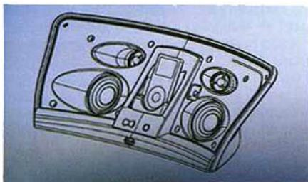
La struttura dell'iGroove come appare in un disegno CAD. È evidente la disposizione dei trasduttori e le smussature che permettono al suono di fluire liberamente.
