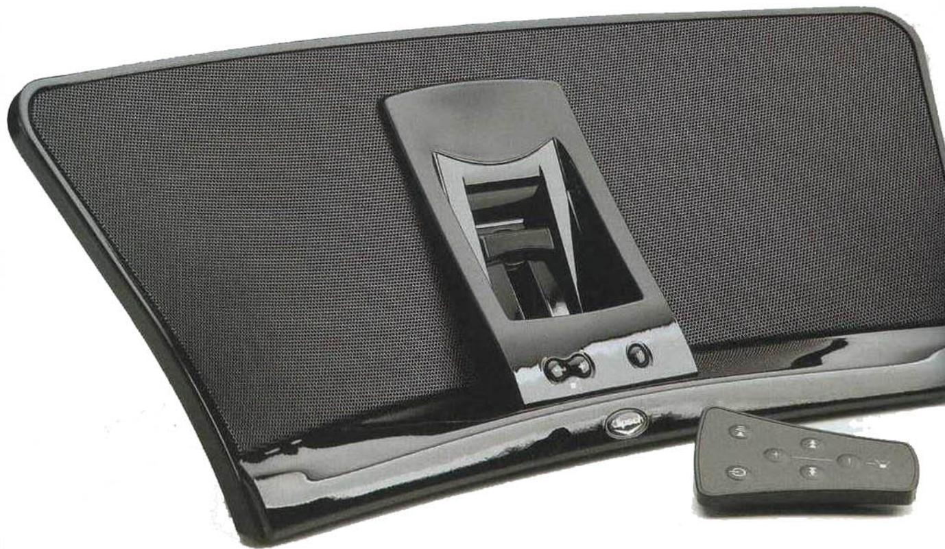
per ognuna delle due tensioni. Si capisce perciò la presenza di un connettore multipolare simile ad un DIN e la massima pressione sonora dichiarata: i 98 dB SPL a 1 m presuppongono infatti un'amplificazione piuttosto corposa, ben foraggiata dai quasi 40 W erogati dall'alimentatore.
